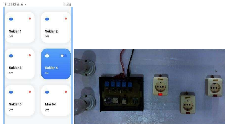
Gambar 12. Saklar 4 pada aplikasi rumah pintar berbasis website , stopkontak 2 pada alat menyala.
