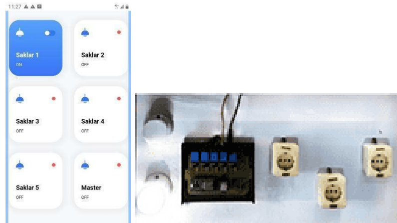
Gambar 9. Saklar 1 pada aplikasi rumah pintar berbasis website , lampu 1 pada alat menyala.
